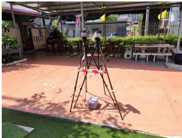
รูปที่ 3.13 การตรวจวัดระดับเสียงโดยทั่วไป และระดับเสียงรบกวน วิทยาลัยเทคโนโลยีกรุงเทพ
